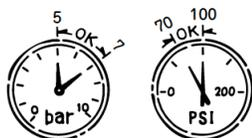
Das Werkzeug ist für einen Druckluftbereich von 70 psi bis 100 psi (5 bis 7 bar) vorgesehen. Der Druck sollte entsprechend der zu befestigenden Werkstücke eingestellt werden. Das Werkzeug darf niemals bei einem Betriebsdruck über 120 psi (8,3 bar) verwendet werden.
